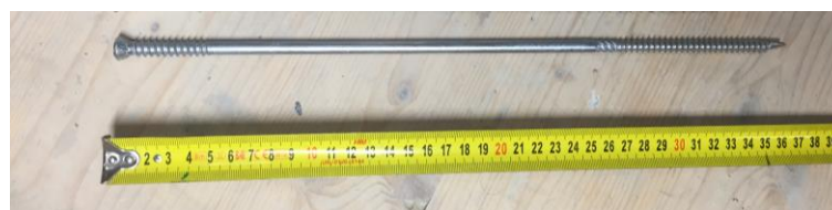
Abbildung 12: Im Projekt Schutz.aufs.Dach verwendete Unterkopfgewindeschraube zur Reduktion des Anpressdrucks zwischen Konterlattung und Dämmstoff
